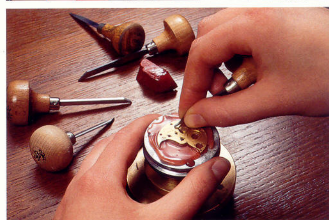
Die Dreiviertelplatte wird von Hand graviert
